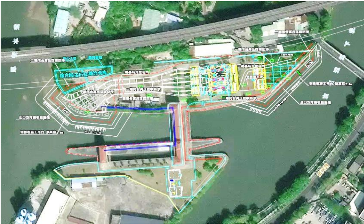
图 3.5-1 石鼓泵站施工总体布置图
